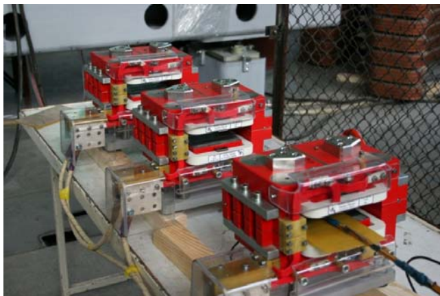
Рис. 24. Включенные последовательно и запитанные от одного генератора бамп-магниты в измерительном отсеке. Четвертый магнит – на оптической скамье (рис. 21).
