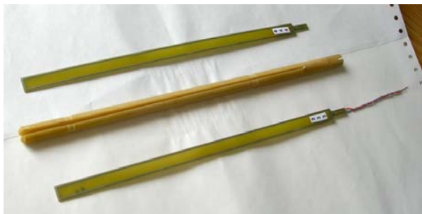
Рис. 22. Катушка измерителя магнитного поля.
