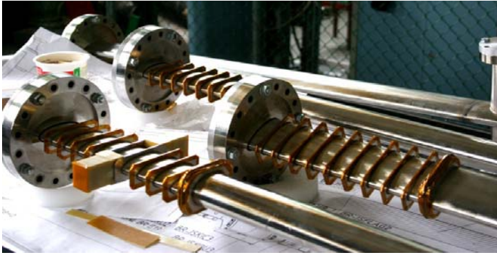
Рис. 14. Вакуумные камеры бамп-магнитов.
