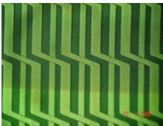
Рис. 15. Фотография считывающей платы. Слой с наклонными полосками находится над слоем с прямыми полосками.
