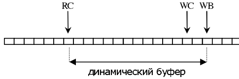
Рис. 7. Фрагменты в буфере ПБВ. RC – указатель чтения, WC – указатель записи, WB – ограничитель указателя записи WC. Указатели занимают правильное положение: WC находится между RC и WB.
