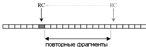
Рис. 9. Пример перевызова одного потерянного фрагмента. Серым цветом отмечен потерянный фрагмент. После сдвига RC кроме потерянного фрагмента повторно придет массив уже полученных ранее фрагментов.
