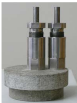
Рис. 9. Токоввод с изолятором (слева) и мишень с нагревателем и токовводом в сборе (справа).
