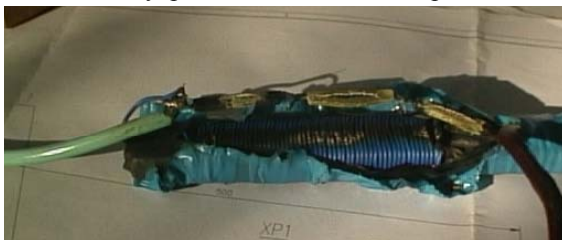
Рис. 13.1. Фотография демпфера через 10 мин работы.
