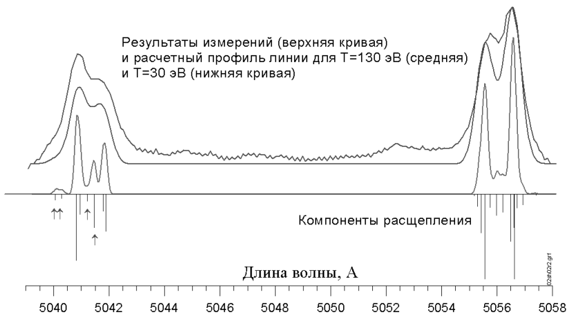
Рис. 7. Зеемановское расщепление \sigma -компонент триплета {}^2D - {}^2P Si II – снизу расчет, верхняя кривая – экспериментальные данные.
