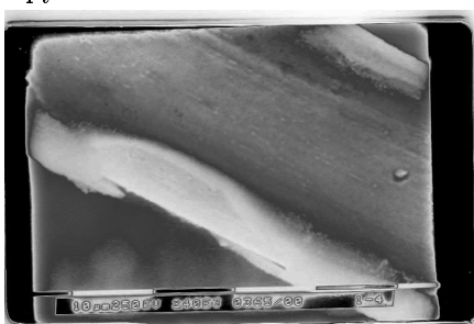
Фотография 9. Поверхность анодной проволочки. Газ – ДМЭ. Материал – герметик КС-5.
