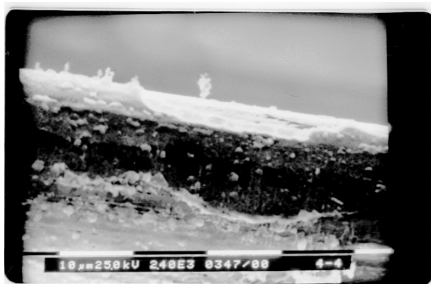
Фотография 7. Поверхность анодной проволочки. Газ – CO 2 /изобутан. Материал – ПВХ трубка.
