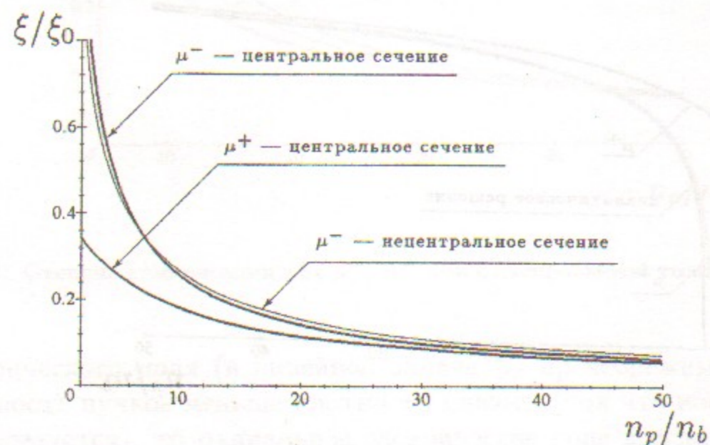
Рис. 7: Степень компенсации при оптимальной толщине плазмы.
