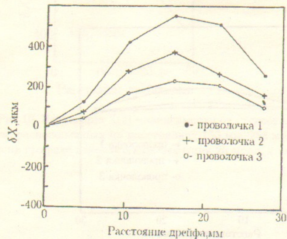
Рис.8. Искажения X(t) – зависимости для суперслоя от экрана под потенциалом земли, расположенного на расстоянии 25 мм от него.
