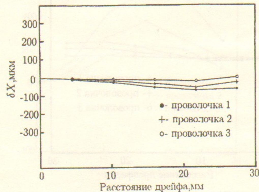
Рис.6. Искажения X(t) – зависимости для расстояния между суперслоями 25 мм.
