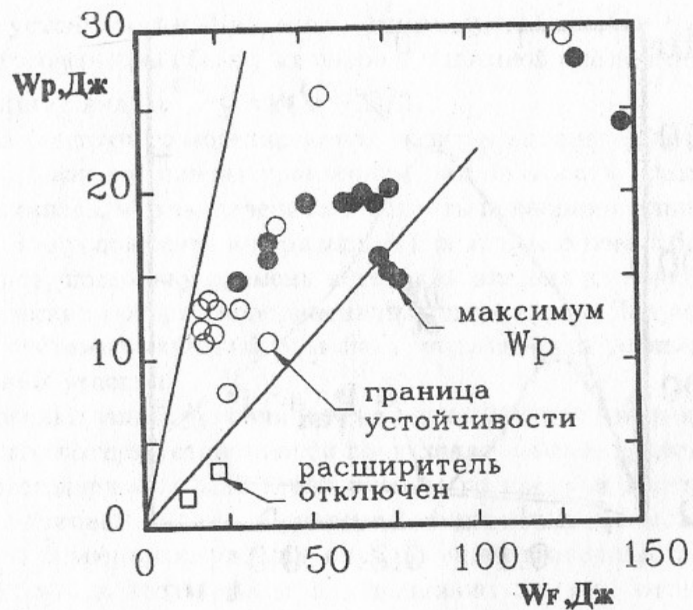
Рис. 7: Энергосодержание быстрых ионов и мишенной плазмы, измеренные на границе МГД-устойчивости.
