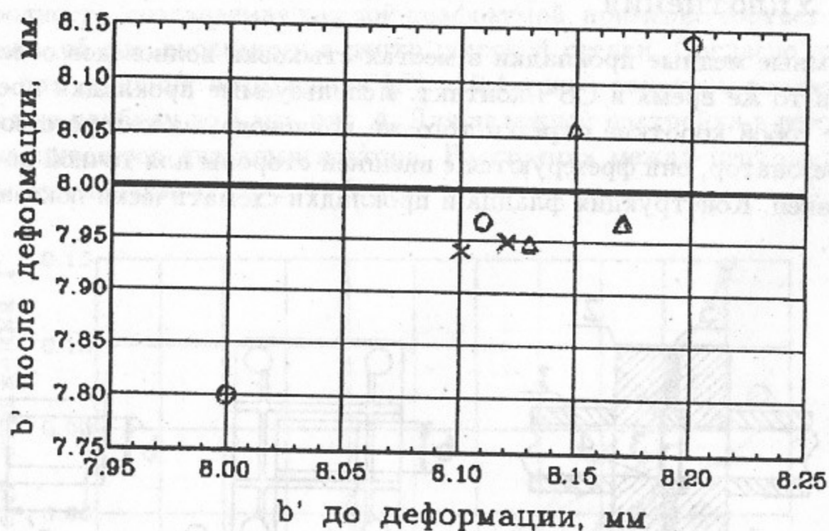
Рис. 6. Деформация прокладок с разной высотой отверстия.
