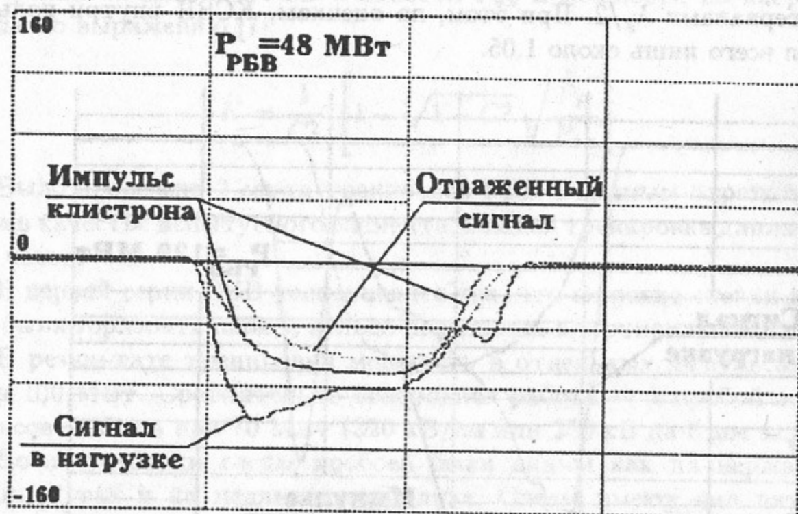
Рис. 8. Форма импульсов на РБВ. Испытания направленного ответвителя.
