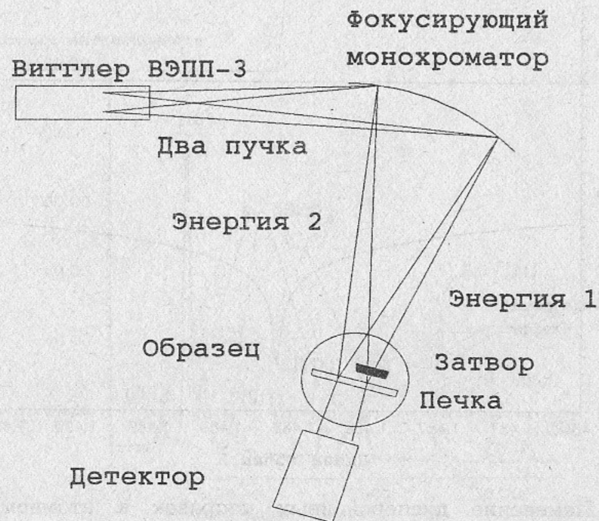
Рис.3. Схема эксперимента двухлучевого аномального рассеяния.
