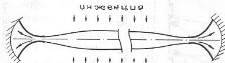
Рис. 9. Газодинамическая ловушка. Короткими стрелками показано направление инжекции нейтральных атомов, длинными стрелками — поток плазмы в расширитель. Выделены участки силовых линий, вносящие благоприятный вклад в «интеграл устойчивости» (29) (из работы [1]).
