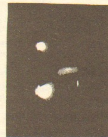
Рис.4. Свечение в зоне столкновения облаков титановых паров при испарении мишени в двух точках. Экспозиция 1,7 мкс.
