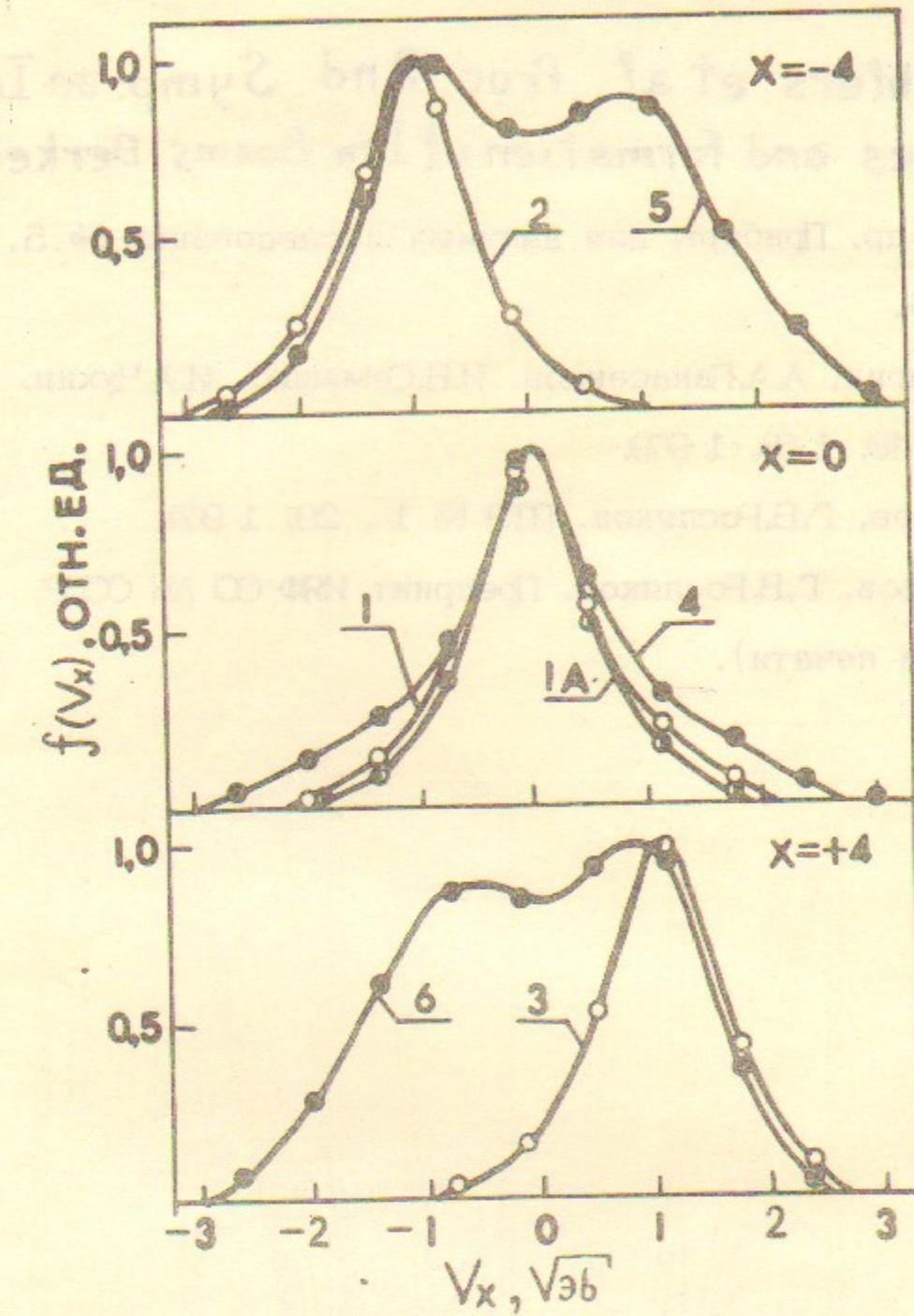
Рис. 3. Функции распределения протонов в эмиттере по поперечным скоростям.
