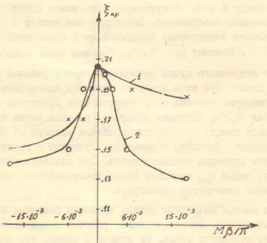
Рис.4. Зависимость  $\xi_{kp}$  от величины линейной связи.  $\left\{ \frac{M\beta_x}{\pi} \right\} = 0,08$ . Кривая I:  $X_0 = 2 + 6$ ,  $Z_0 = -0,02$ ;  $\beta_{x0} = \beta_{z0} = 0$ . Кривая 2:  $X_0 = 1,4 + 4,2$ ;  $Z_0 = X_0 + 0,02$ ;  $\beta_{x0} = \beta_{z0} = 0$ .
