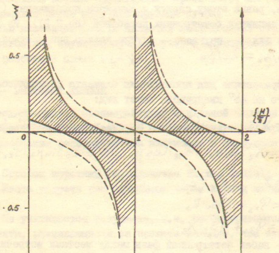
Рис. I. Условие устойчивости (2.6) малых колебаний. По горизонтали отложена дробная часть величины  $M/\beta$ . Значение  $\xi < 0$  соответствует встречным пучкам одного знака. Пунктирная кривая—при отсутствии связи ( $M=0$ ), заштрихованная область—для связи  $M \cdot \beta = 1$ .
