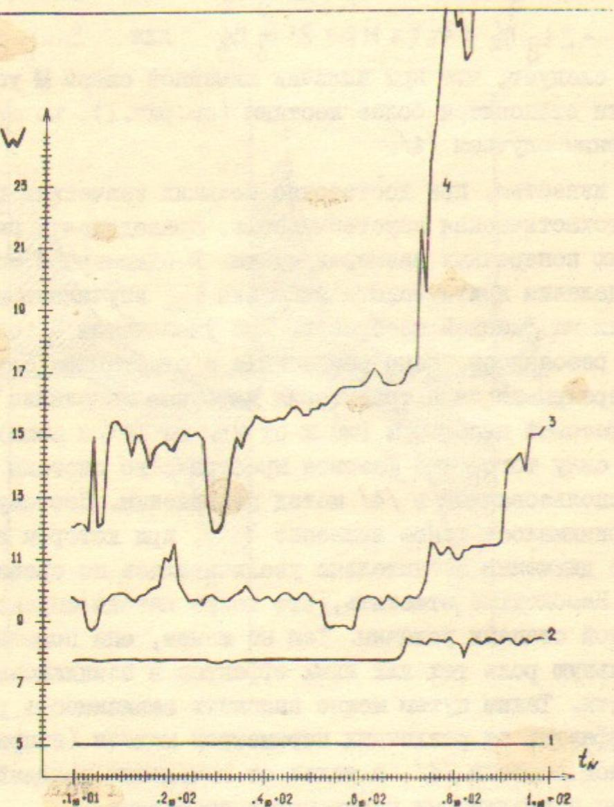
Рис. 2. Зависимость величины  $W$  (см §2) от времени для значений:  $\{\beta_k\}_x = 0,0785, \{\beta_k\}_z = 0,0815, \xi_x = 0,18, \xi_z = 0,18$ . Кривая 1:  $X_0 = 1,42; Z_0 = 1,40$ ; кривая 2:  $X_0 = 2,82, Z_0 = 2,80$ ; кривая 3:  $X_0 = 4,22, Z_0 = 4,20$ ; кривая 4:  $X_0 = 5,62, Z_0 = 5,60$ . Для всех кривых  $\varPhi_{x0} = \varPhi_{z0} = 0$ .
