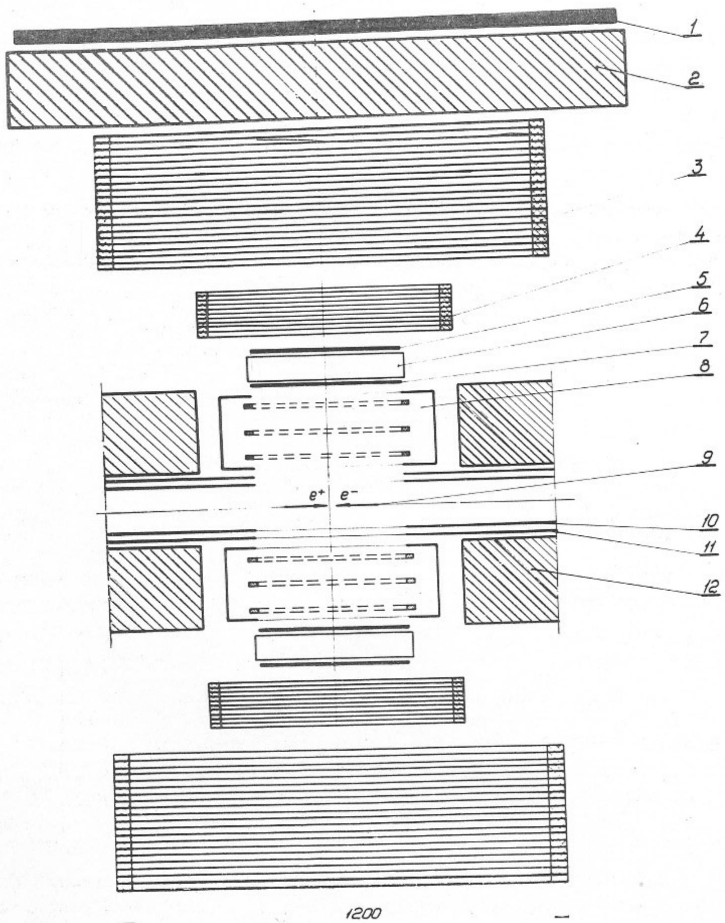
Рис.1. Система регистрации: 1-сцинтилляционный счетчик антисовпадений; 2-свинец; 3-пробежная искровая камера; 4-ливневая искровая камера; 5,7-сцинтилляционные счетчики; 6-водянной черенковский счетчик; 8-координатные проволочные искровые камеры; 9-область встречи; 10,11-внутренняя и наружная вакуумная камеры; 12-магнит накопителя.
