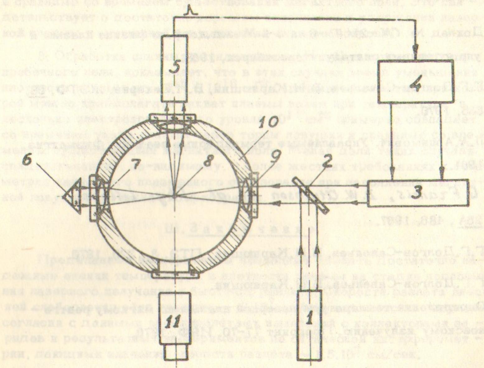
Рис.1. Схема эксперимента. 1 - гелий-неоновый лазер, 2 - стеклянная пластина, 3 -  $Nd^{3+}$  лазер, 4 - блок синхронизации, 5 - ФЭУ, 6 - призма полного внутреннего отражения, 7, 9-лизы, 8 - мишень, 10 - вакуумная камера, 11 - ЭОП.
