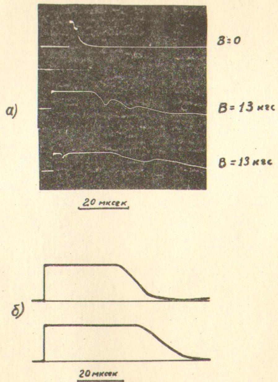
Рис.6. Осциллограммы сигнала отсечки. а) плазма без поля и в пробочном поле; б) - плавная осциллограмма для плазмы в пробочном поле (вверху) и типичная осциллограмма отсечки во встречных полях (внизу).
