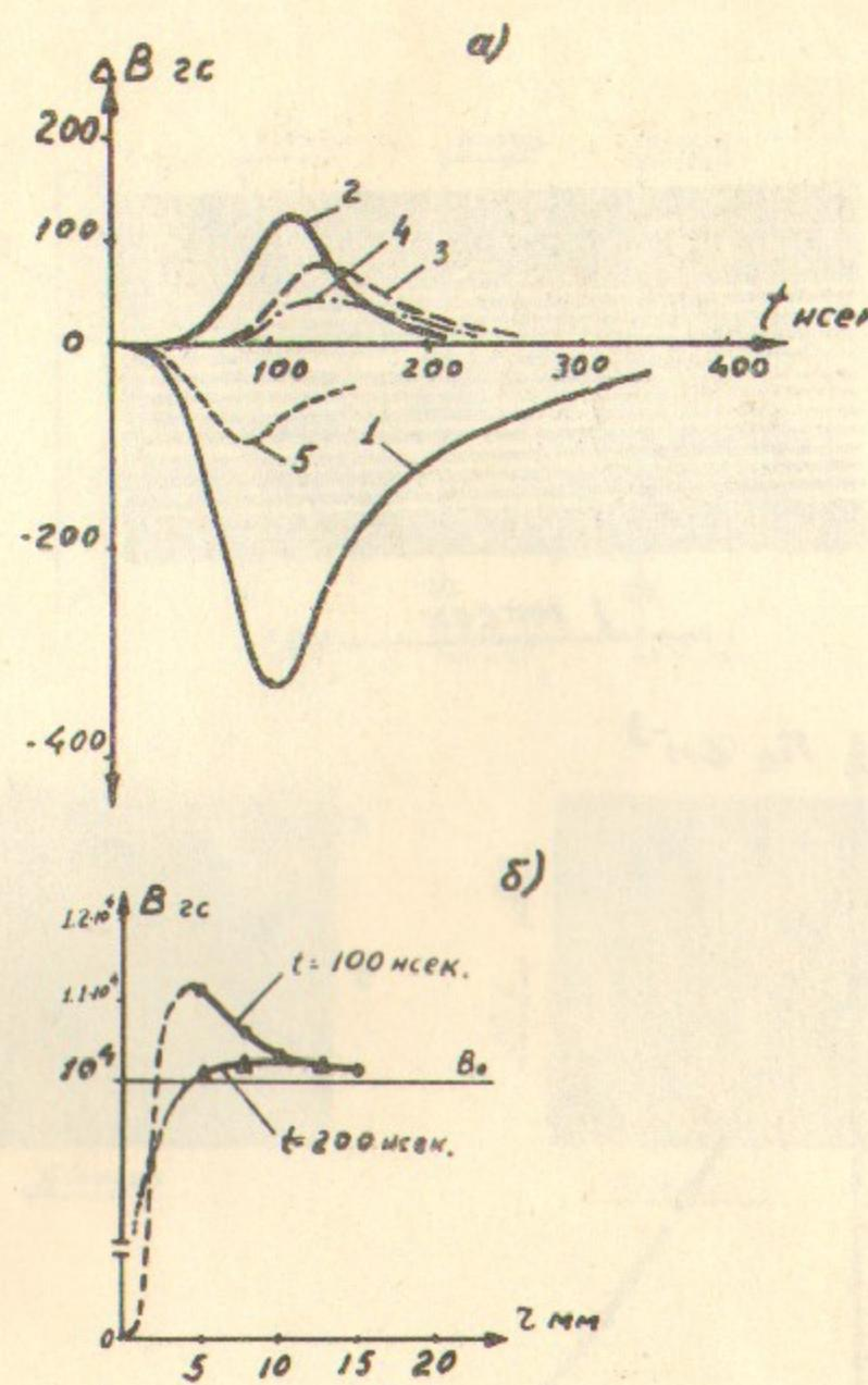
Рис.5. Магнитозондовые измерения: а) кривые 1,2,3,4 получены при расстояниях от центра зонда до оси камеры 0,5, 10 и 15 мм соответственно, 5 - вариация среднего потока для зонда диаметром 2 см; б) - кривые пространственного изменения магнитного поля.
