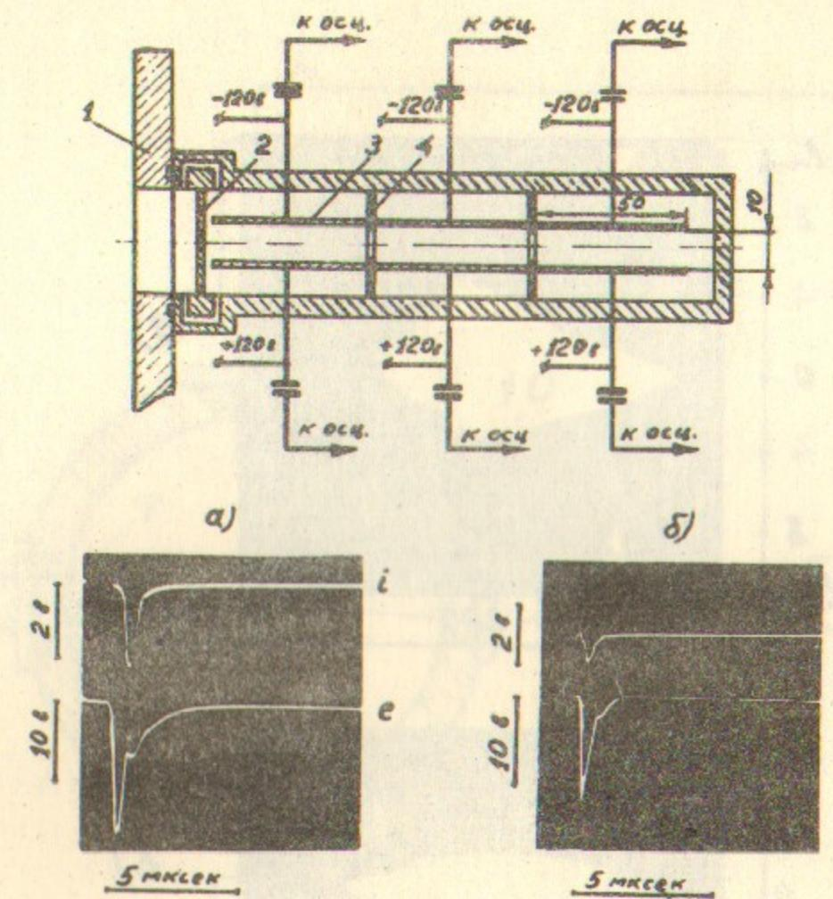
Рис.3. Вверху схема устройства коллектора: 1 – стенка камеры, 2 – диафрагма, 3 – электрод, 4 – изолятор.
