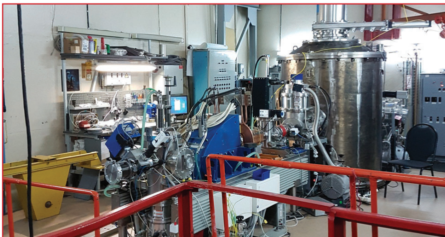
Ускорительный источник нейтронов для БНЗТ. Фото Александра Макарова.
